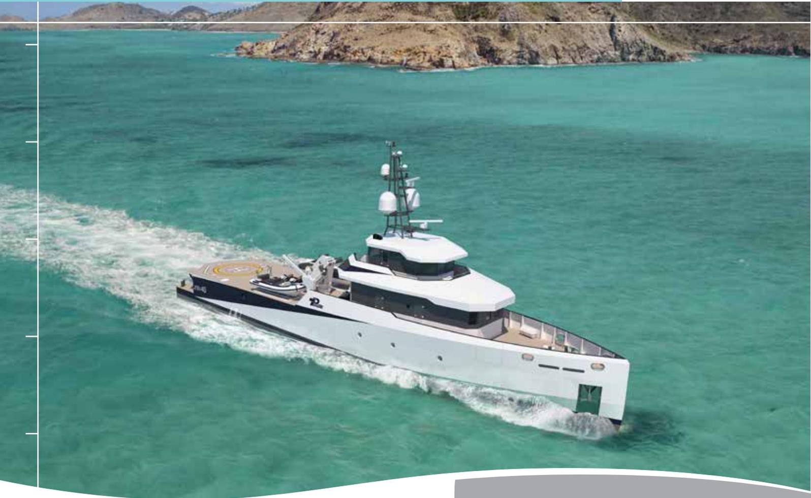
Le YSV 40 de PIRIOU est un navire de soutien océanique rapide, capable de transporter tous les équipements de loisirs et techniques du yacht mère. Issue de la coque de notre Fast Passenger and Supply Vessel FPSV 40, sa carène en acier lui permet de supporter toutes les conditions de navigation.
