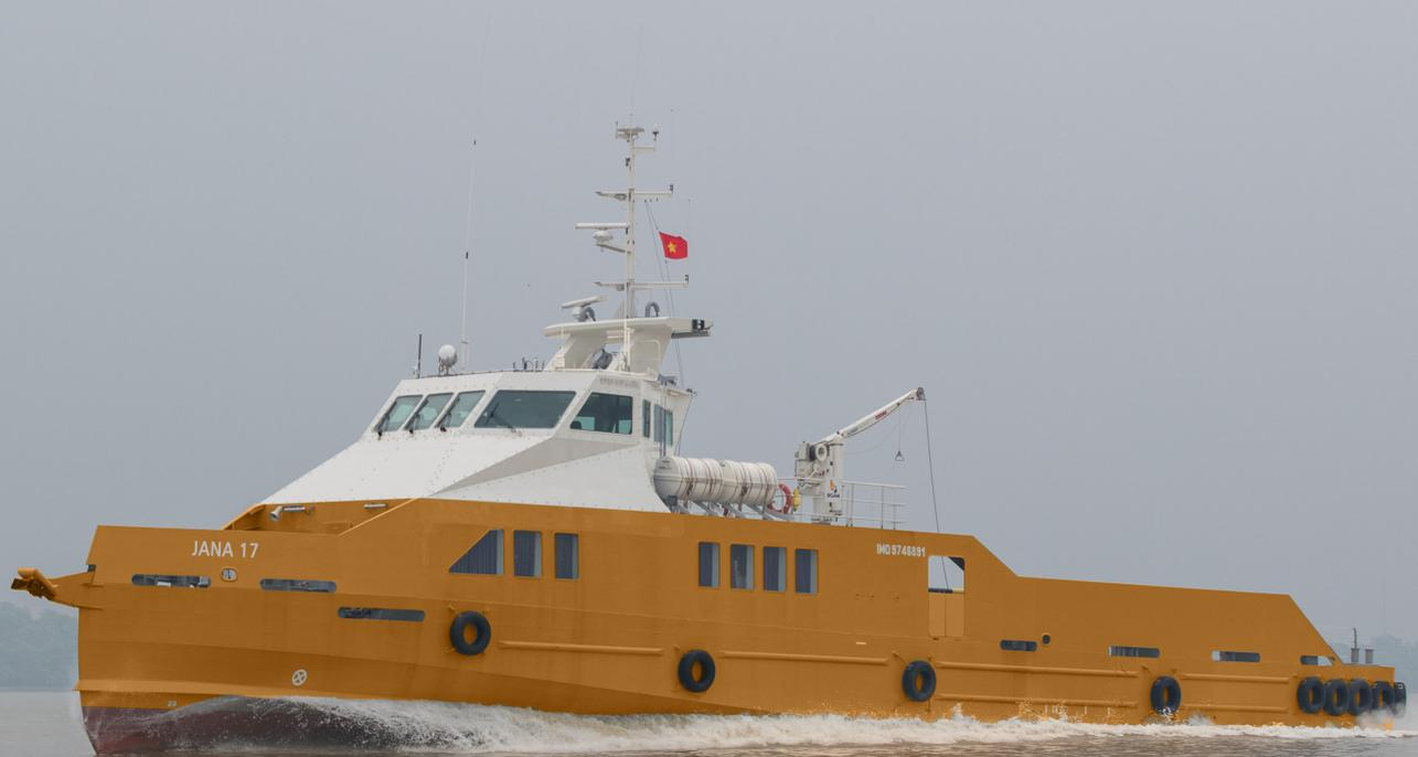
Fort de ses 25 années d'expérience dans la construction de navires de transfert rapide pour l'industrie offshore, PIRIOU a conçu le FPSV 41P. Équipé de 80 sièges et d'un pont de chargement de 100 m<sup>2</sup>, c'est le navire idéal pour les opérations de transfert de personnel et de transport rapide d'équipements.
