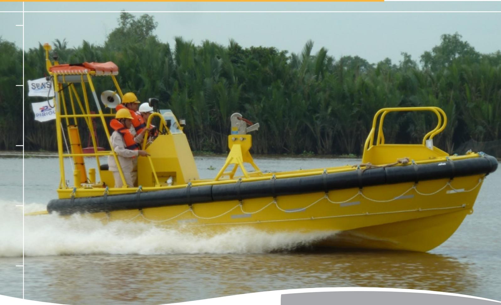
Cette embarcation de sauvetage initialement conçue pour équiper les Navires de Soutien Rapides (OSV) est aussi adaptée aux transferts de personnel sur de courtes distances grâce à sa proue de débarquement standardisée.
