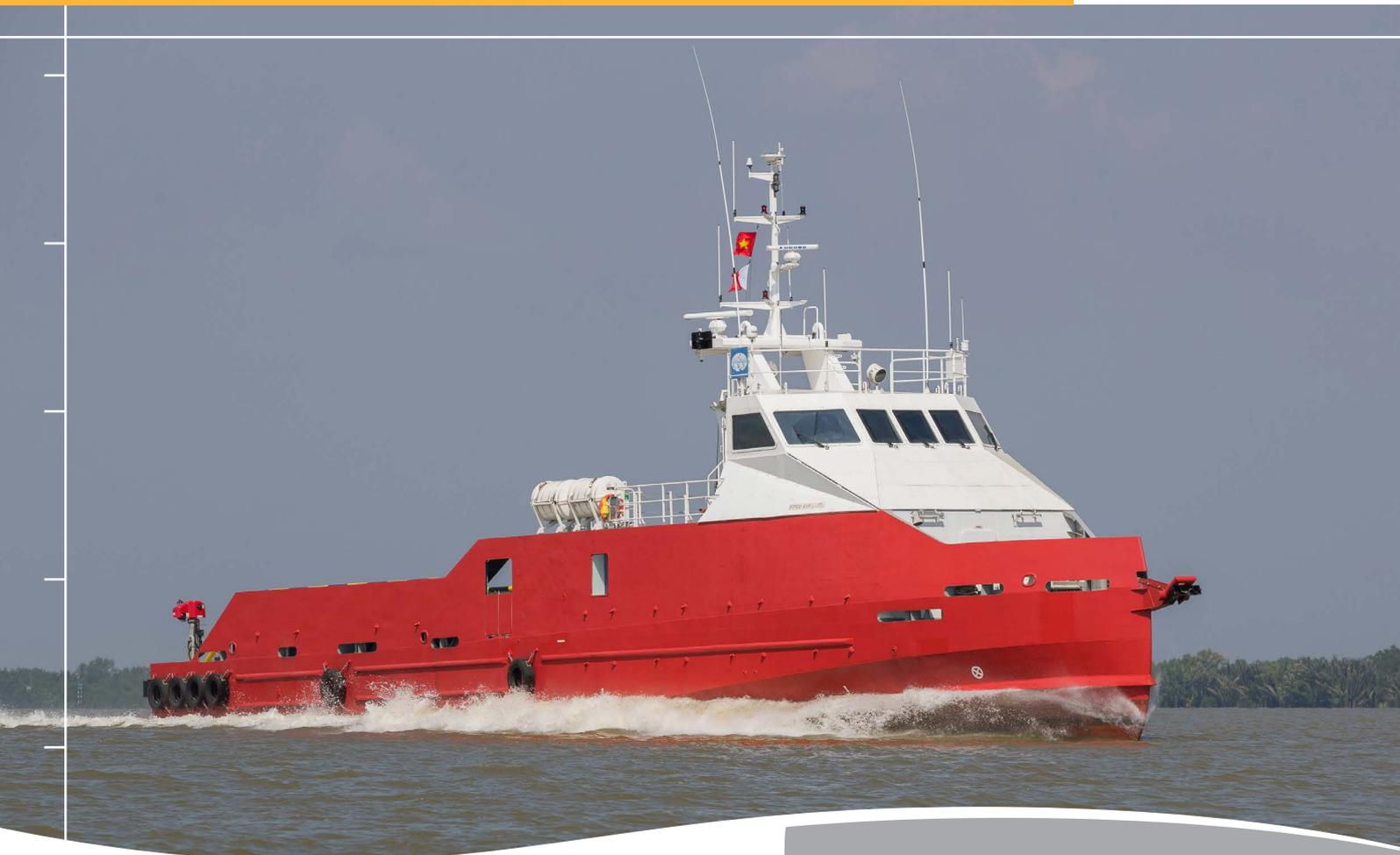
Navire en aluminium très polyvalent, le FPSV 41P Security assure des missions multiples pour l'industrie offshore, notamment le transport de personnel et de fret en pontée.
