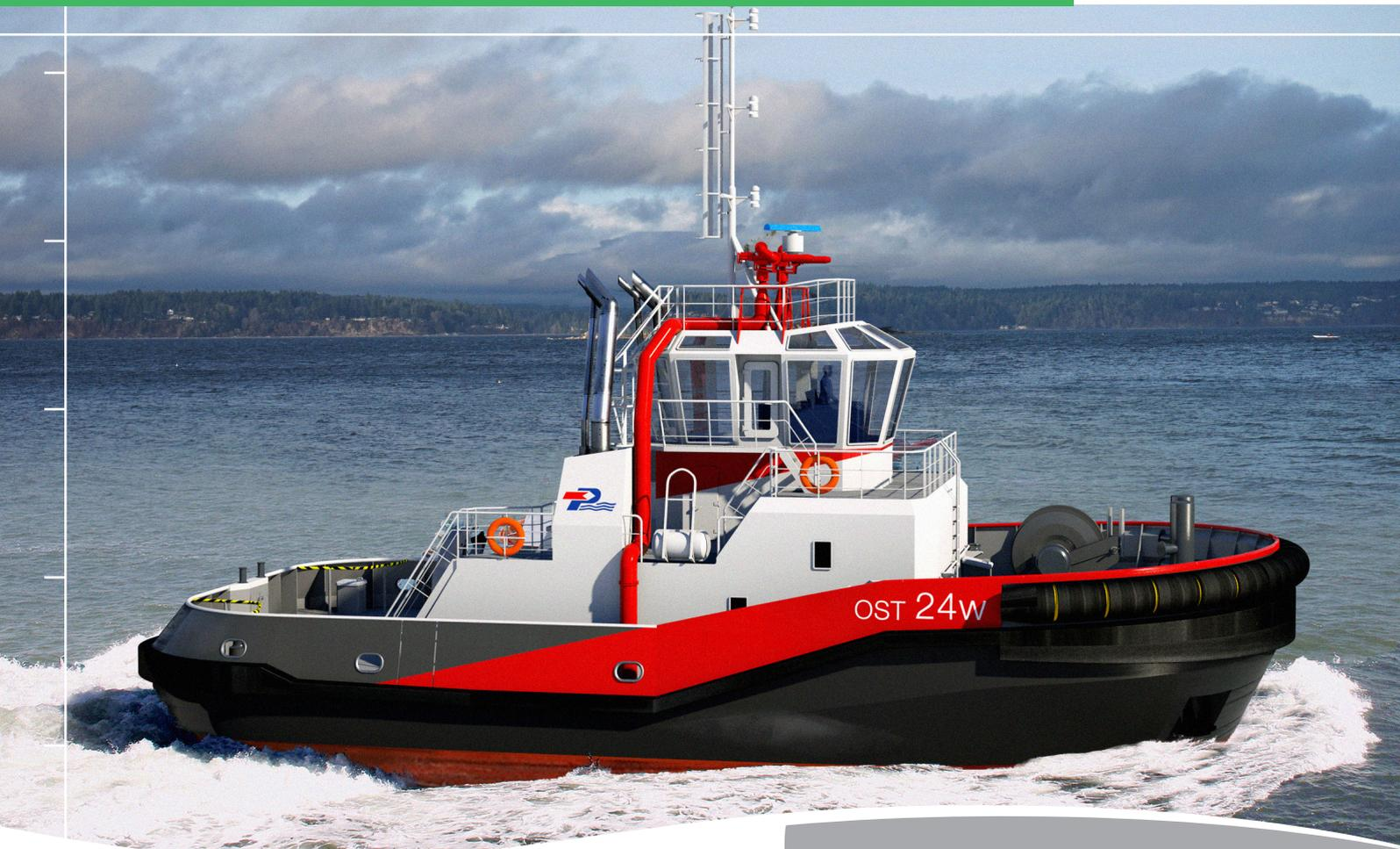
L'OST 24 W est un modèle issu de la célèbre famille des remorqueurs OST portuaires polyvalents conçus par PIRIOU, particulièrement large, avec une puissance de traction jusqu'à 74 tonnes. Des variantes avec moteurs semi-rapides sont disponibles pour les modèles de 45 et 65 tonnes de traction. Ces remorqueurs standard sont construits en série afin d'être rapidement disponibles.
