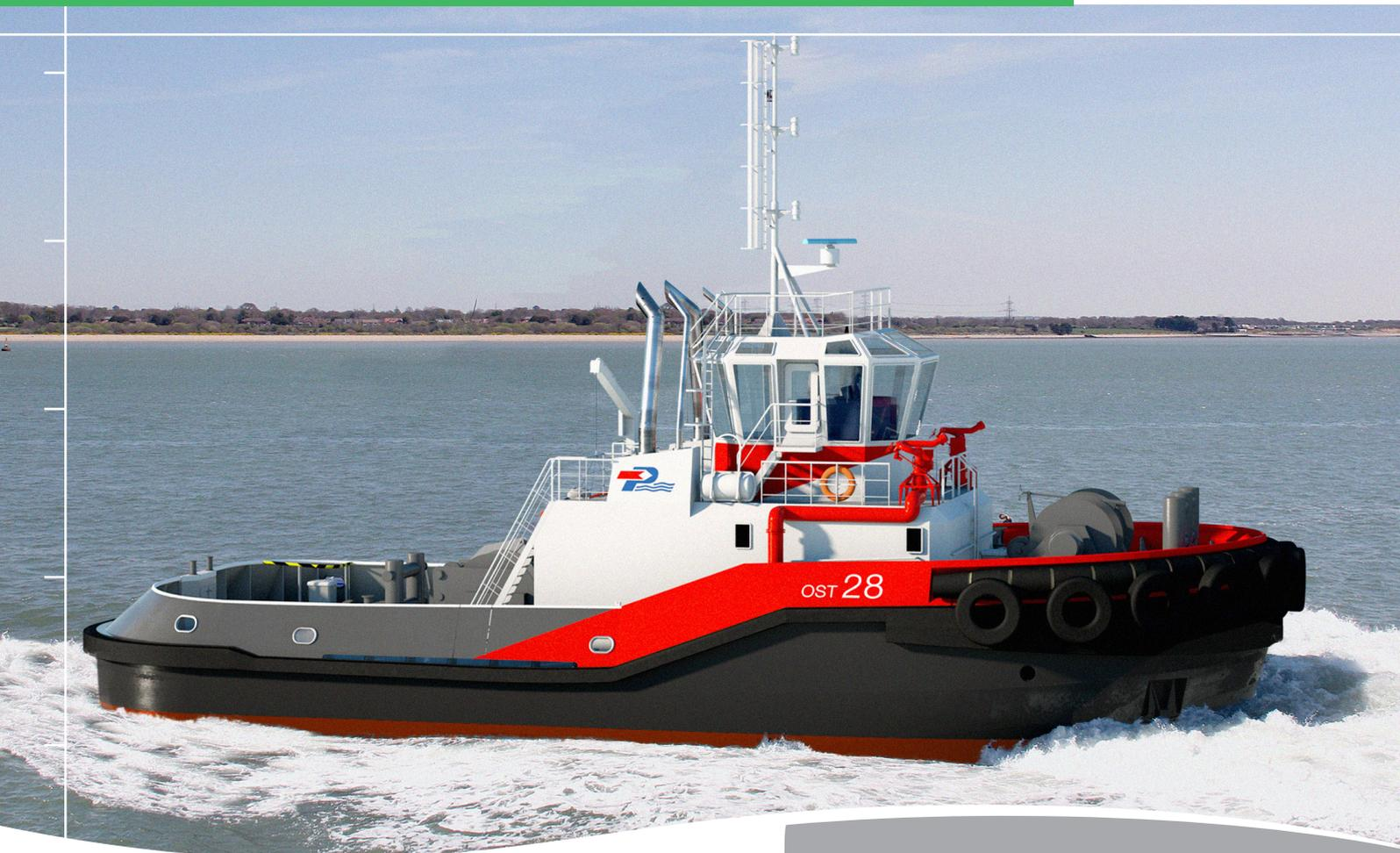
L'OST 28 fait partie de la célèbre famille des remorqueurs OST portuaires polyvalents conçus par PIRIOU avec une puissance de traction jusqu'à 60 tonnes. Ces remorqueurs standards sont construits en série afin d'être rapidement disponibles.
