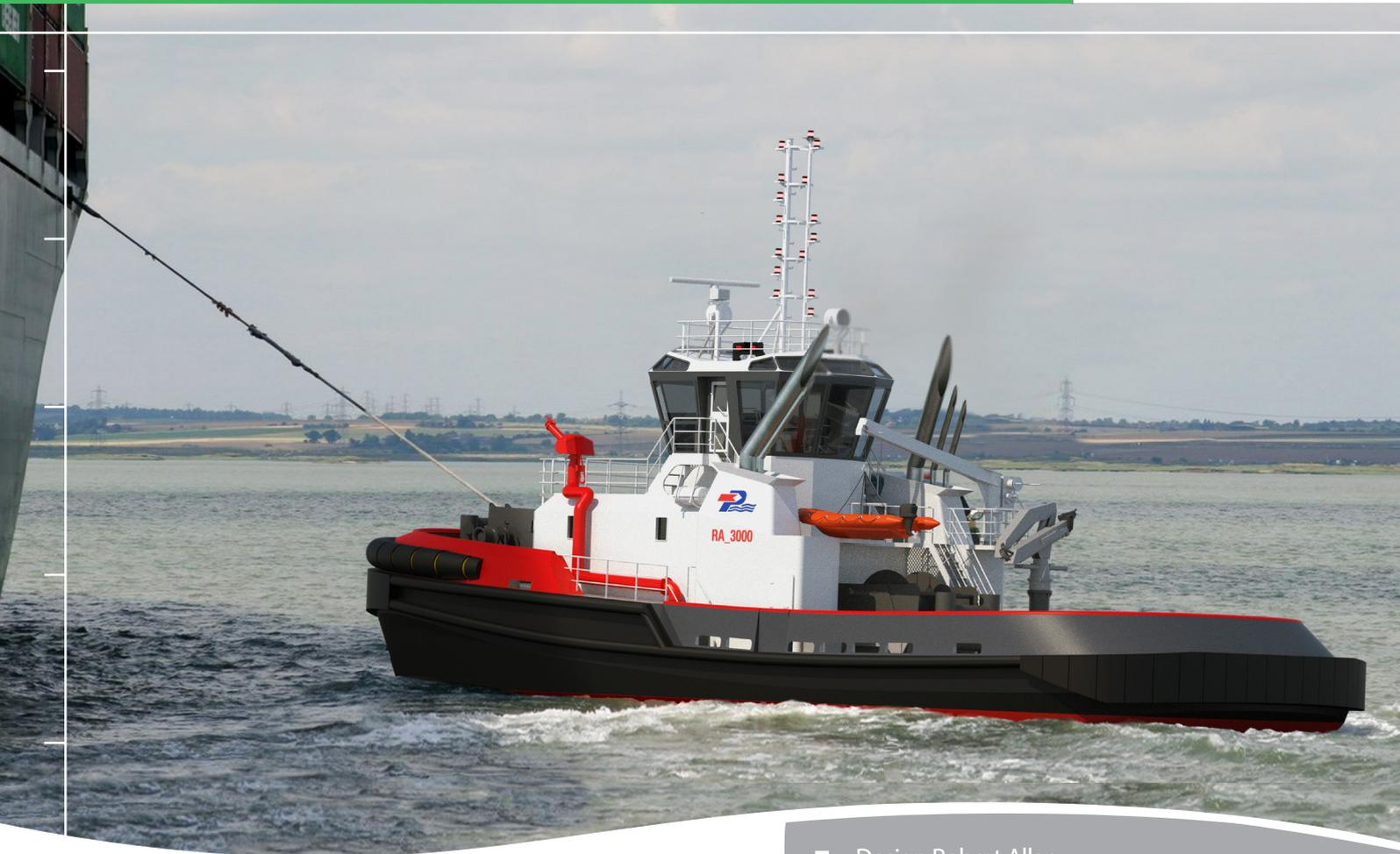
PIRIOU vous propose une nouvelle gamme de remorqueurs ASD conçus par Robert Allan. Le RAmparts 3000 offre une puissance de traction de 70 à 80 tonnes assurée par des moteurs rapides ou semi-rapides.
